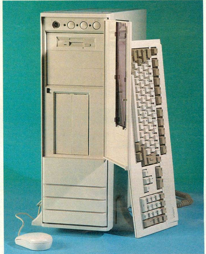
Der Amiga 4000 Tower: In voller Pracht steht er da, im elegantem Design mit fünf frei zugänglichen Schächten
