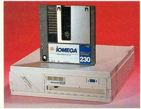
Bernoulli: Das Diskettenprinzip auf Leistung gebracht – mit 230 MByte
