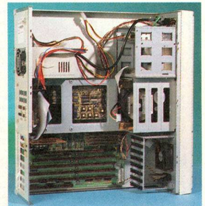
Innen: Gut erkennbar die fünf Amiga- und vier PC-Steckplätze sowie die zwei Video-Slots
